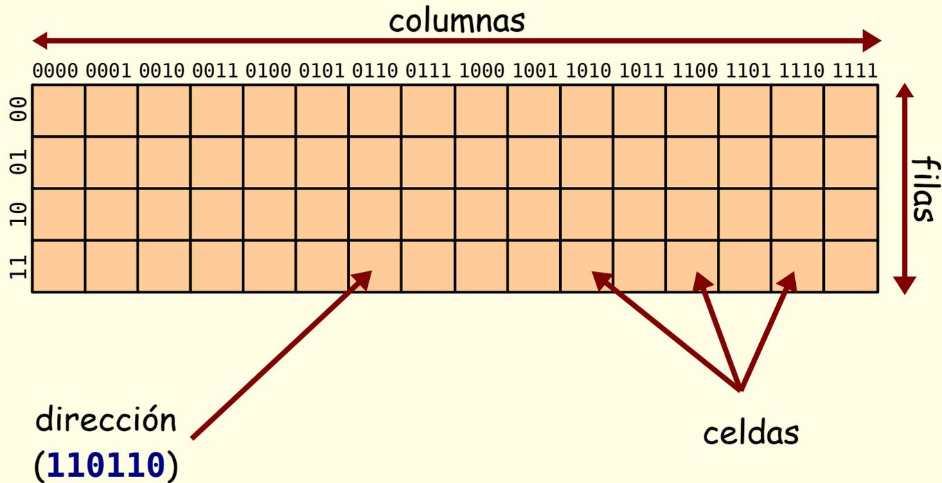
**tamaño: (cant. filas) x (cant. cols) x (bits x celda)**
